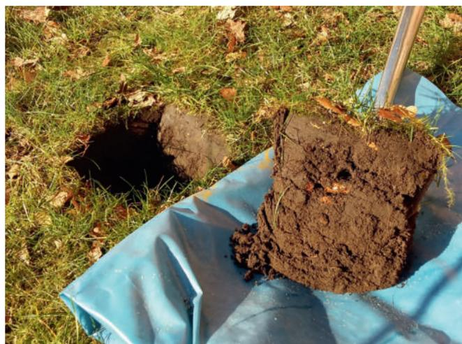
Der Bodenziegel wird mit vier senkrechten Stichen ausgehoben und auf einer Plane abgelegt. Er kann nun nach und nach in zunächst grobe und dann kleinere Klumpen bis hin zu kleinsten Krümeln zerlegt werden.
