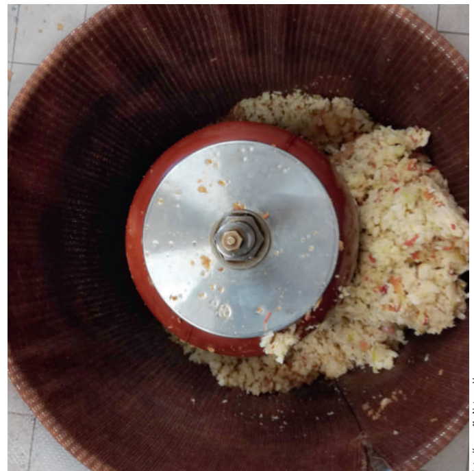
Vor dem Pressvorgang: Die Maische wird in den Presssack gefüllt. In der Mitte befindet sich die dehnbare Gummimembran.
