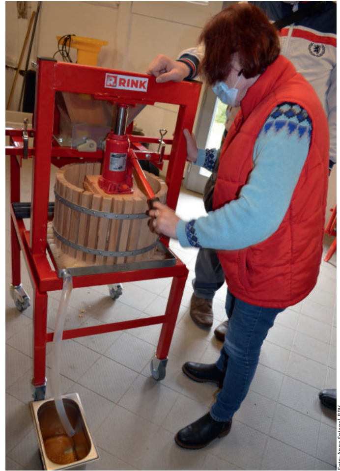
Eine Kleinkorbpresse mit hydraulischem Druckwerk in Form eines Wagenhebers.
