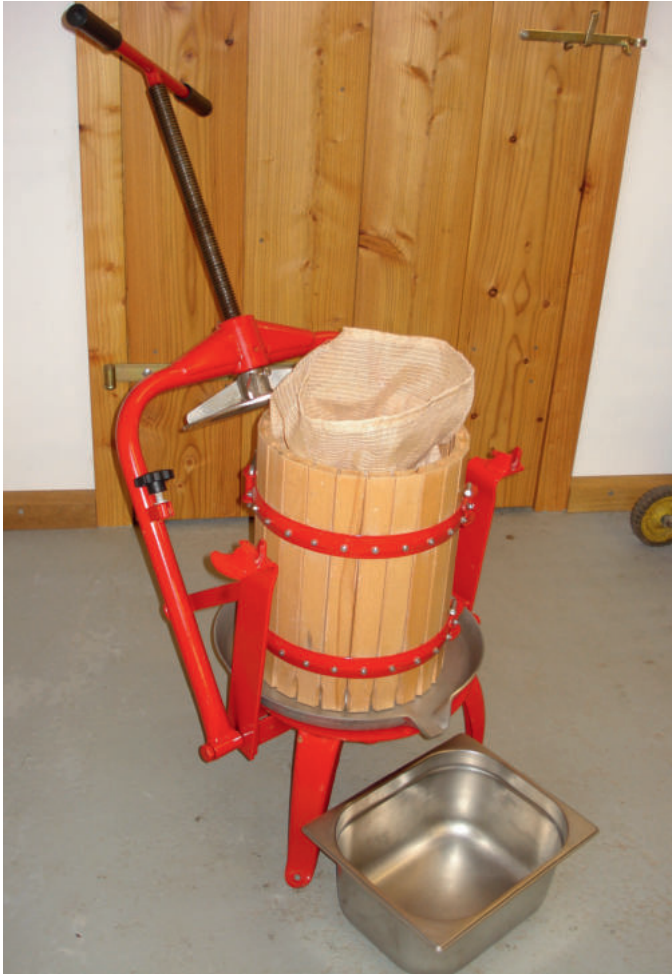
Eine mechanische Spindelpresse.
